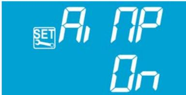
En esta función hay que ajustar los siguientes parámetros: "trEt" intervalo de tiempo en el cual, si no recibe un pulso, se bloquea la centralita. Programable entre 3 y 20 min (de fábrica 10 min.). "PoUt" indica el tipo de salida del relé seleccionado para la señal de alarma. Si es 0, la señal es continua, y si es un valor entre 1 y 10, será el tiempo en segundos de la alternancia encendido/apagado en el relé. Por último "rELE" que nos indica el relé sobre el que actúa esta señal de alarma.
