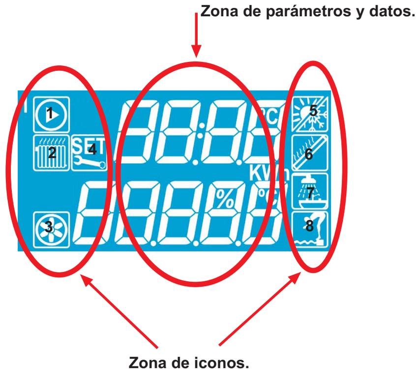
**Zona de parámetros,** en esta parte de la pantalla se muestran los datos que nos puede proporcionar la centralita o los parámetros que estamos modificando con sus valores.
